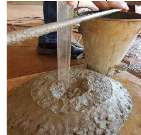
Figura 2. Ensaio de abatimento por tronco de cone.
