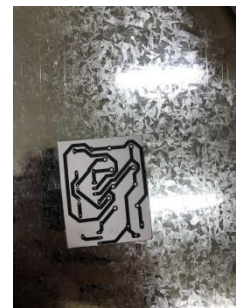
Figura 3. Placa antes de corroer.
