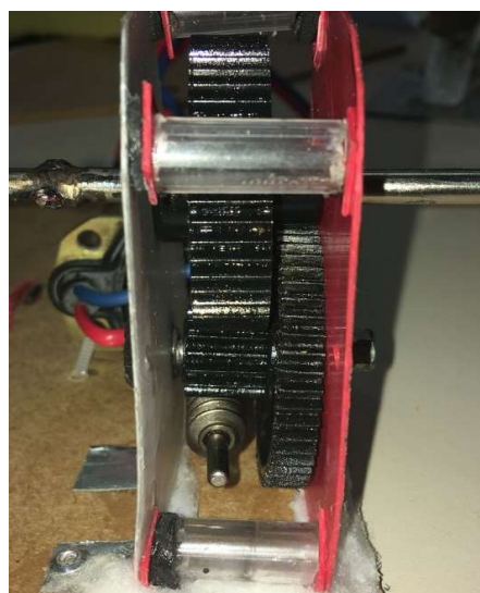
Figura 2. Caixa de redução acoplada ao eixo.
