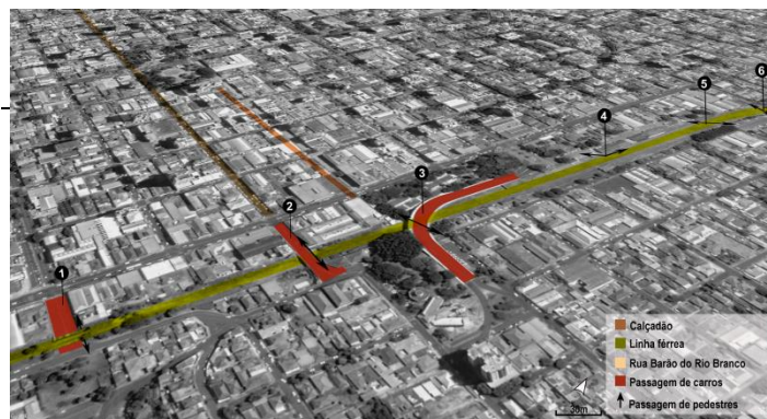
Figura 2: Principais passagens de pedestres e automóveis na linha férrea
