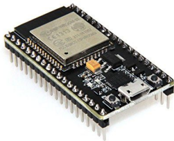
Figura 5. Módulo WiFi ESP32 Bluetooth
